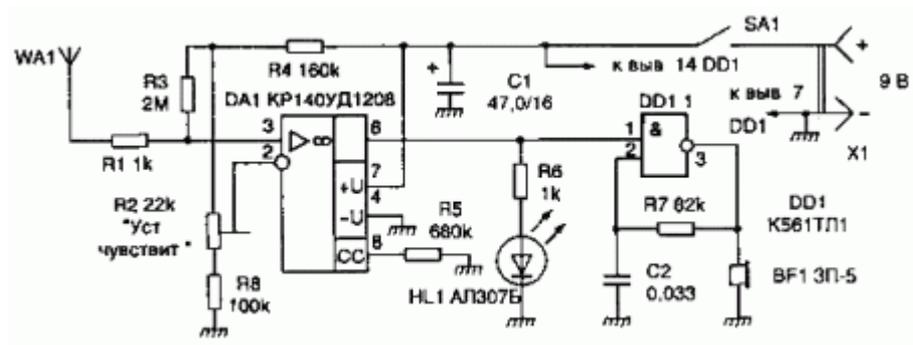
Монтажную плату размещают в корпусе из диэлектрического материала так, чтобы антенна оказалась в головной части и была максимально удалена от руки оператора. На лицевой стороне корпуса располагают выключатель питания SA1, светодиод HL1 и звукоизлучатель BF1. Начальную чувствительность прибора устанавливают подстроечным резистором R2.
