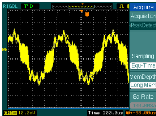
Рисунок 2-70. Осциллограмма сигнала, режим пикового детектора
