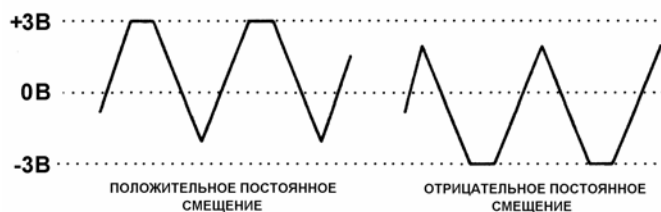
Рисунок 2-13. ОБРЕЗАНИЕ СИГНАЛА ПРИ ПОСТОЯННОМ СМЕЩЕНИИ
