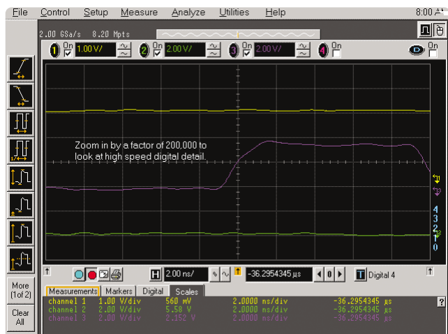
Рисунок 2 - При использовании коэффициента масштабирования 200000:1 можно визуально оценить время нарастания тактового сигнала динамического ОЗУ
